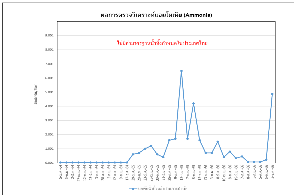
รูปที่ 3.5.5.2-8 เปรียบเทียบผลการวิเคราะห์แอมโมเนีย (Ammonia) บ่อพักน้ำทิ้งหลังการบำบัด
