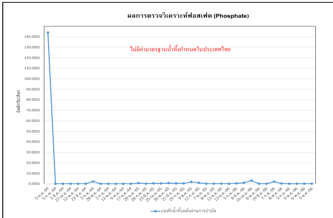
รูปที่ 3.5.5.2-11 เปรียบเทียบผลการวิเคราะห์ฟอสเฟต (Phosphate) บ่อพักน้ำทิ้งหลังการบำบัด
