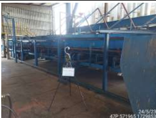
ระบบสายพานลำเลียงกากอ้อยบริเวณหม้อไอน้ำ
