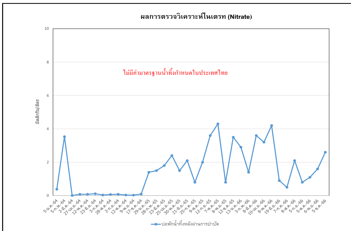
รูปที่ 3.5.5.2-7 เปรียบเทียบผลการวิเคราะห์ไนเตรท (Nitrate) บ่อพักน้ำทิ้งหลังการบำบัด
