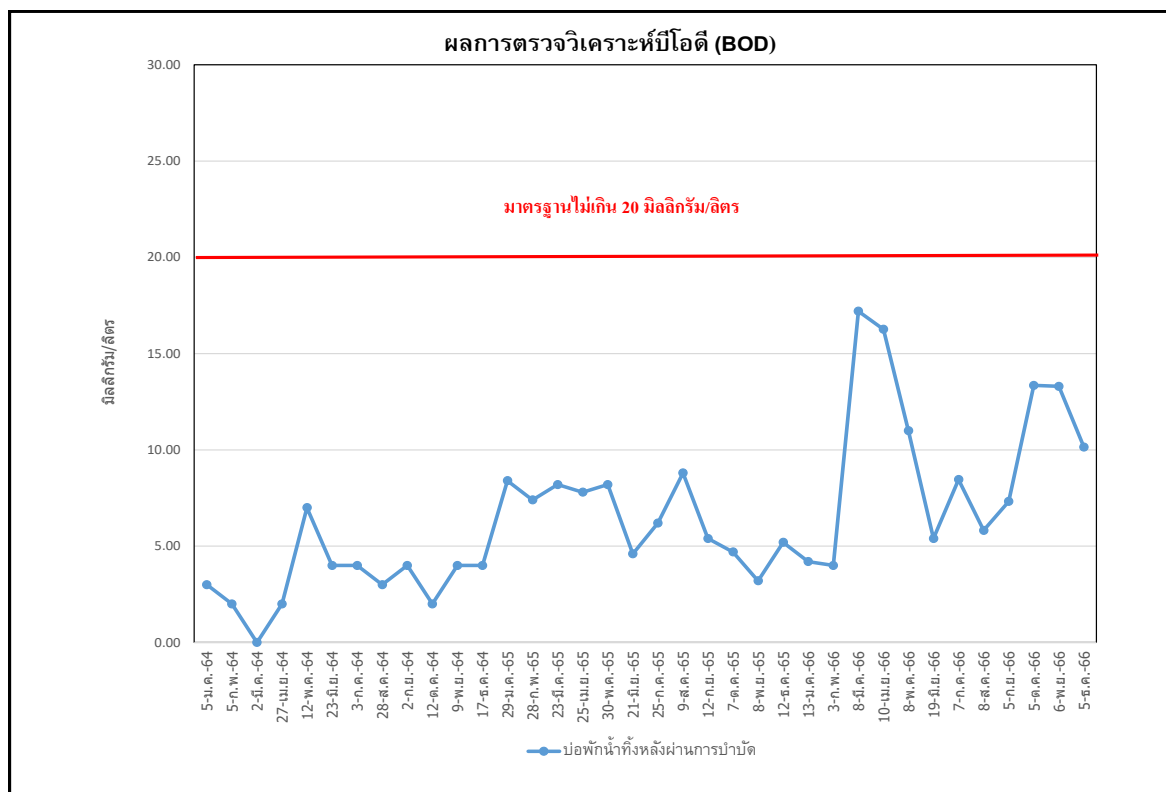
รูปที่ 3.5.5.2-3 เปรียบเทียบผลการวิเคราะห์บีโอดี (BOD) บ่อพักน้ำทิ้งหลังการบำบัด
